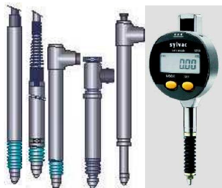
Rys. 8 Czujniki transformatorowe przemieszczenia
